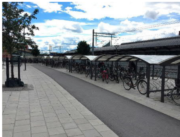
Figur 3.6 Cykelparkering vid Jakobsbergs station. Väderskyddad cykelparkering med möjlighet att låsa fast cykelramen. Parkeringsskeppen är svåra att snöröja maskinellt.
